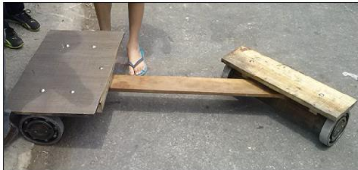
Figura 1: Carrinho de rolimã construído com madeira e rolamentos de aço
