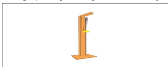
Figura 2 – Equipamento projetado para o experimento de alongamento de uma mola
